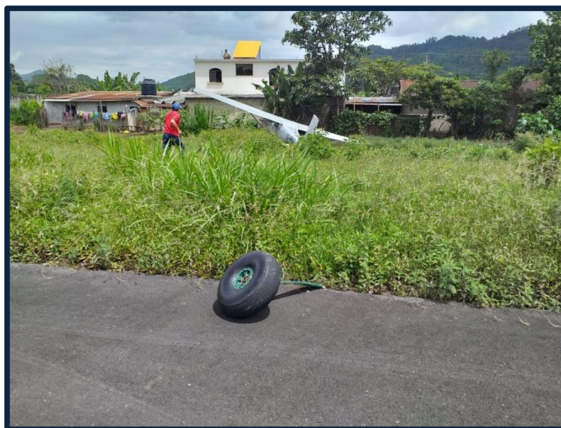
Fotografía No. 5 Vista del tren principal derecho fracturado.
