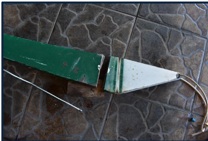
Fotografía No. 14 Quebradura por fatiga del tren derecho.
