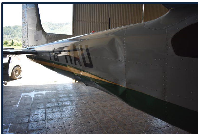
Fotografía No. 16 Daños en el fuselaje lado derecho.
