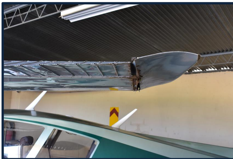
Fotografía No. 15 Daños en el ala derecha.
