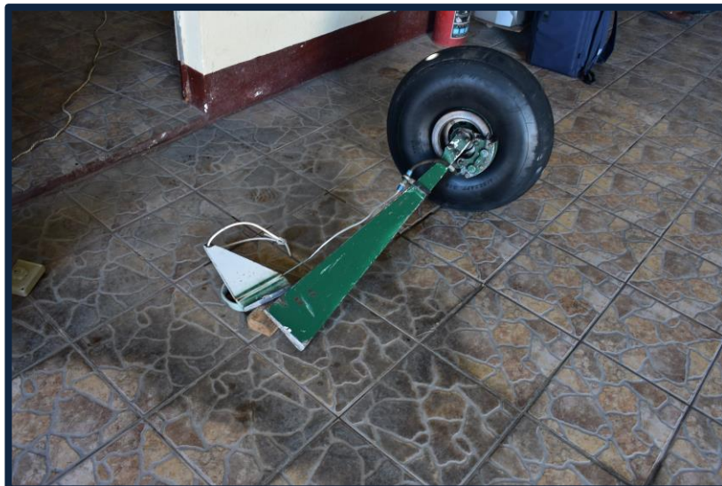
Fotografía No. 13 Tren principal derecho fracturado.
