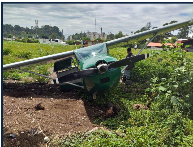
Fotografía No. 4 Vista de daños en el tren principal derecho.
