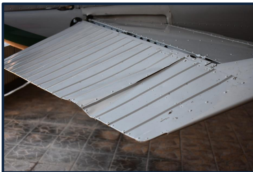
Fotografía No. 21 Vista del daño en el elevador derecho.
