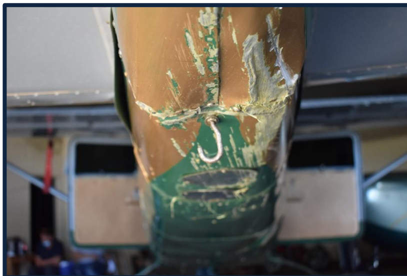
Fotografía No. 18 Daños en el empenaje en parte inferior.
