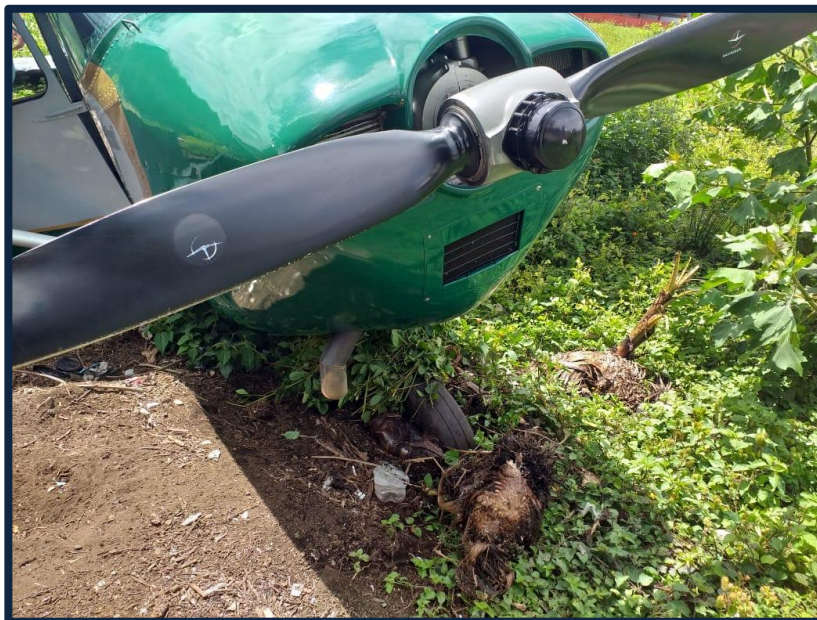
Fotografía No. 3 Vista de los daños en el tren de nariz.
