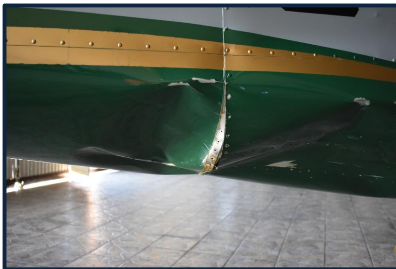
Fotografía No. 17 Daños en el fuselaje inferior en lado derecho.
