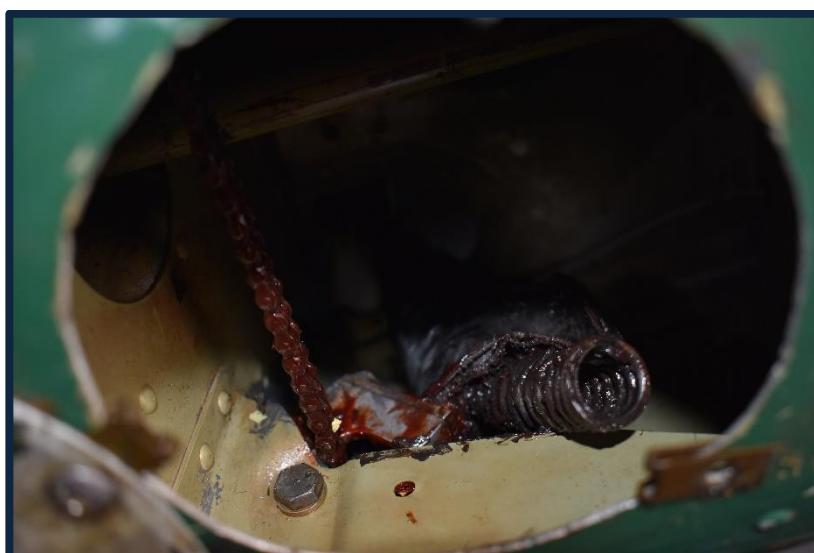
Fotografía No. 22 Soporte del estabilizador fracturado.
