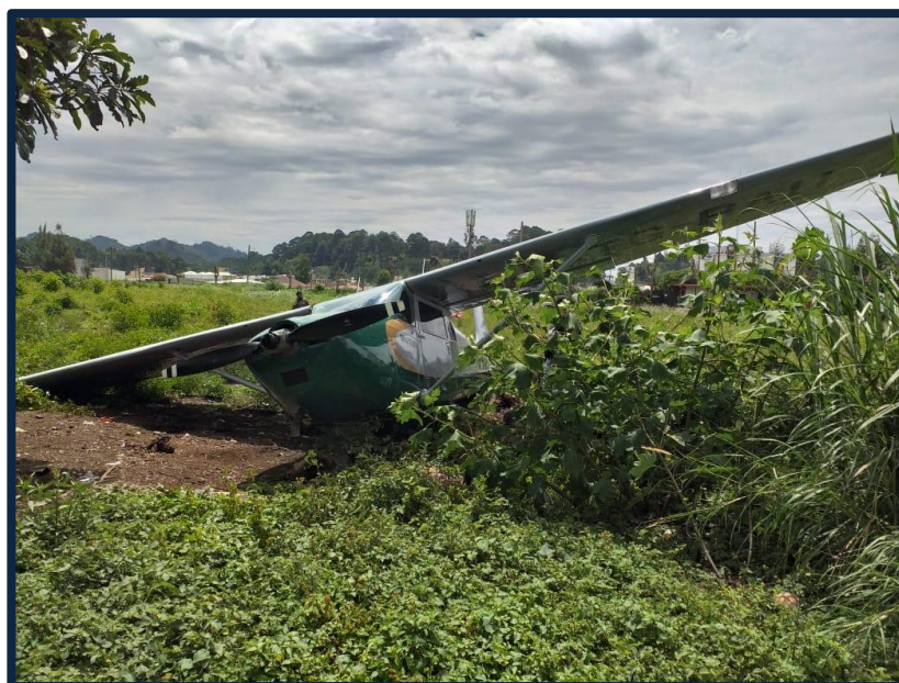
Fotografía No. 6 Vista de daños en el ala derecha.
